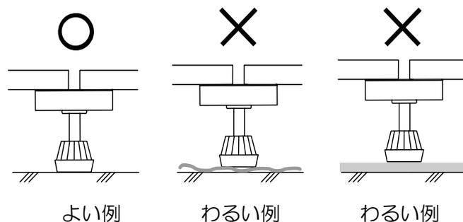
⑥ パーチを1枚張るごとに、水平器またはレーザー水平器でパーチを水平にします。
