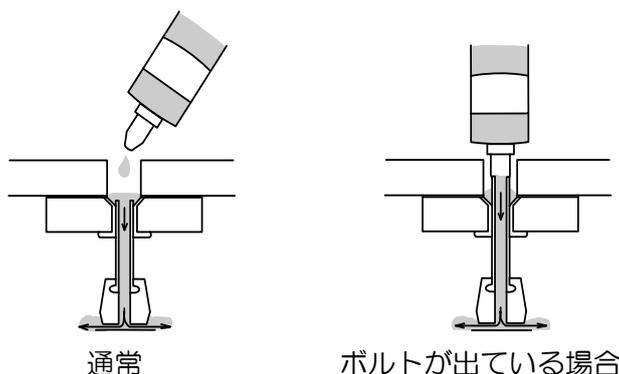
ボルトが出ている場合は、ボルトの頭部にノズルを挿して注入します。
