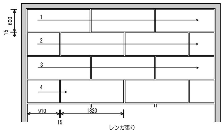
**注意** 張り仕舞いで、パーチの幅が200mm以下になる場合、前の列のパーチの幅を細くするなどして、パーチの幅が200mmより細くならないようにしてください。
